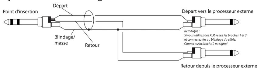
Le départ Send peut aussi servir de sortie directe pré-Fader et pré-EQ, avec la pointe et la bague court-circuitées pour ne pas couper le trajet du signal (voir ci-
